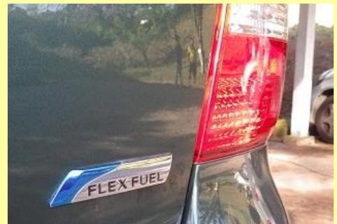
↑ブラジルで走っている車の大部分は「フレックス車」。ガソリンとエタノールを混ぜて利用できます。日本メーカー(ホンダやトヨタなど)も、フレックス車をブラジルで生産しています。
